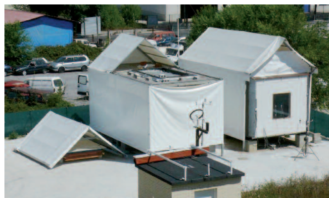
Figura 4. Habitación de ensayos de la célula "Eguzki" (superior) que permite ensaya elementos de fachadas con orientación sur, mientras que la célula "Ilargi" (inferior) permite el ensayo tanto de elementos de fachadas como de cubiertas planas.
