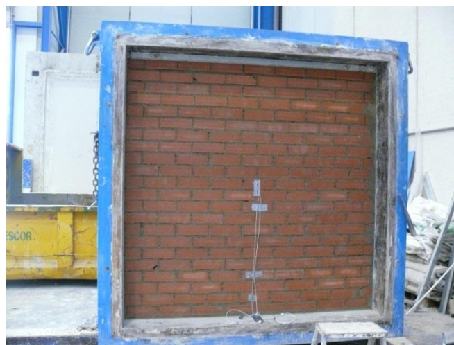
Figura 2.3 – Construcción de la muestra: muro de doble hoja de fábrica de ladrillo
